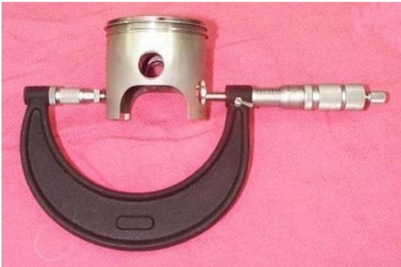
Gambar 5. Cara penggunaan outside micrometer.
