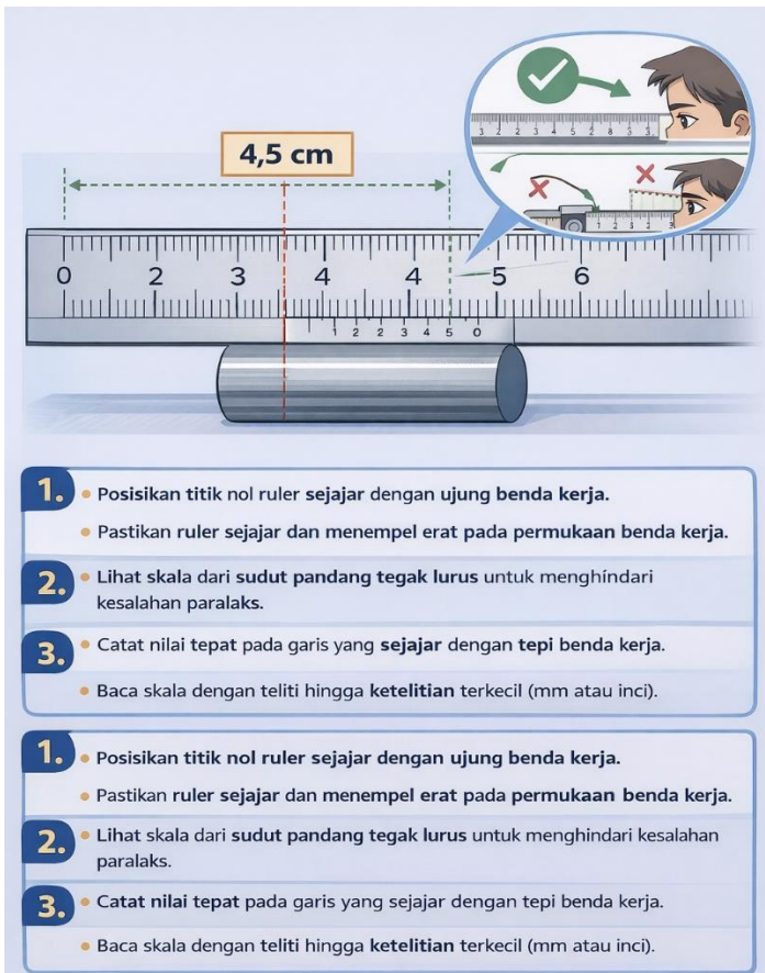
Gambar 32. Ilustasi prinsip pengukuran menggunakan ruller.
