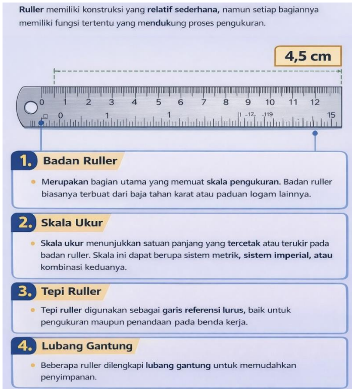
Gambar 33. Bagian-bagian ruller dan fungsinya.
